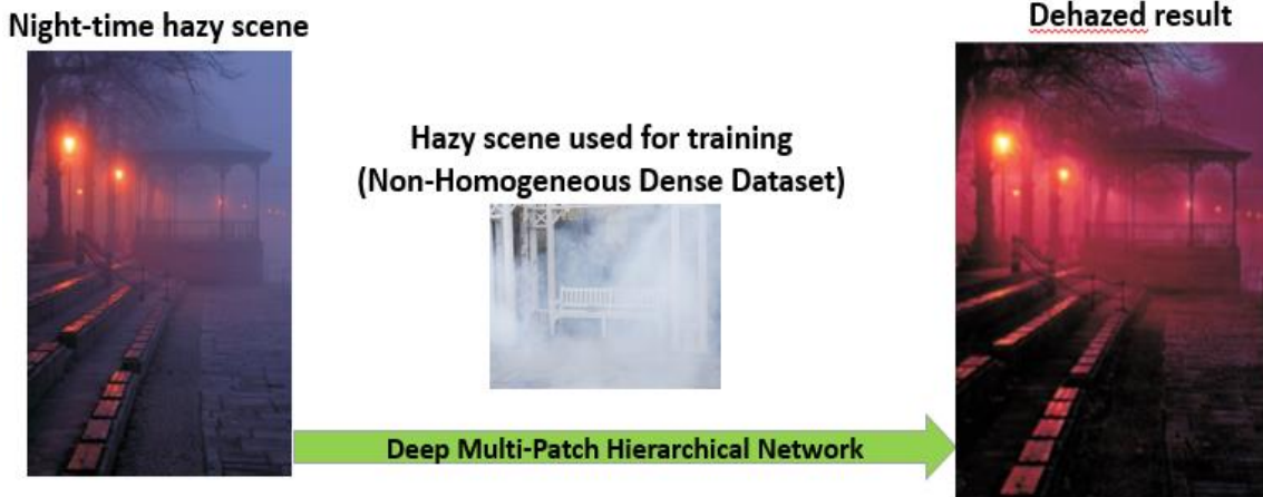
Figura 2. Exemplu de limitare al eficienței algoritmului antrenat (cu perechi de imagini înregistrate în condiții similare de iluminare pe timpul zilei), dacă algoritmul procesează imagini de intrare cu ceață pe timp de noapte.
