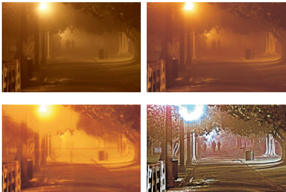
Figura 7. De la stanga la dreapta (prima coloană): imaginea originală cu ceață, imaginea îmbunătățită pe baza DCP fără modificare de culoare. De la stanga la dreapta (a doua coloană): imaginea îmbunătățită cu algoritmul bazat pe DMPHN antrenat cu NH-Haze, imaginea îmbunătățită cu algoritmul bazat pe DMPHN (similar antrenat cu NH-Haze) dar cu adaptare de domeniu.
